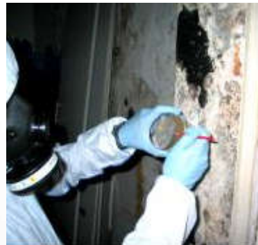
Entnahme einer Probe von Schimmelpilzen auf ein Nährmedium
