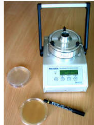
Raumluftmessung auf Schimmelpilze mit einem Luftkeimsammler
